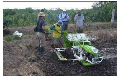
Gambar 4 & 5. Penampakan alat tanam (rice transplanter) sistem tegel siap untuk dilakukan penanaman
